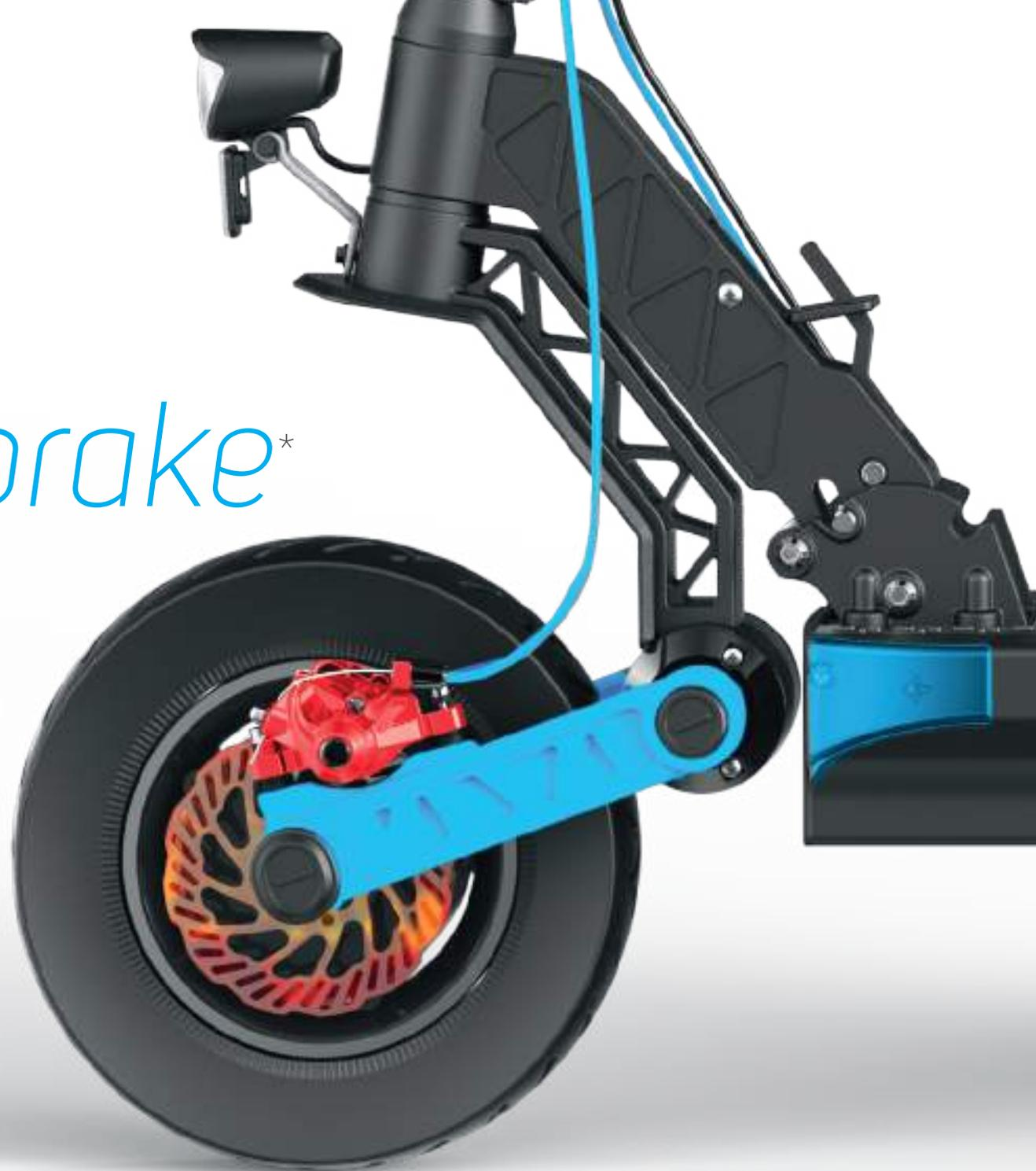
\*Hydraulic brake = Freins hydrauliques • Ou freins à disque mécaniques • Selon référence du produit
