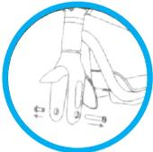
Lösen Sie die Schraube und entfernen Sie die Abdeckung
