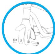
Desparafuse o parafuso e remova o eixo
