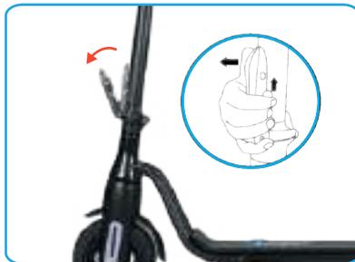
Puxe a alavanca de segurança para cima, depois abaixe a alavanca e dobre o mastro da scooter de volta para a plataforma.
