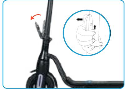
Trek de handgreep veilig omhoog, laat de handgreep zakken en vouw de scootmast terug op het platform.
