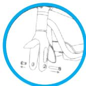
Desatornille el tornillo y retire el eje.
