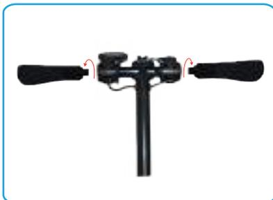
Lösen Sie die Griffe des Scooters für ein kompakteres Zusammenklappen.
