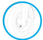
Die Achse einbauen und die Schraube festziehen
