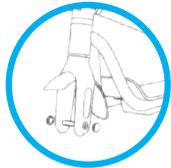
Entfernen Sie die Abdeckungen, die die Schrauben verbergen
