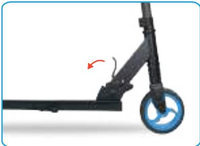
Tire del asa en la parte delantera del scooter, luego baje el poste del scooter a la plataforma.
