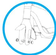
Retirez les opercules masquant la boulonnerie
