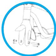
Draai de schroef los en verwijder de as
