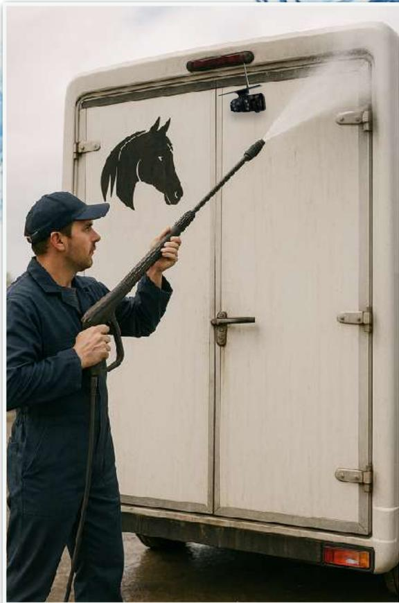
La caméra Beeper WIFI offre une étanchéité lui permettant une utilisation extérieure en conditions atmosphériques intenses et un lavage du véhicule au jet à haute pression
