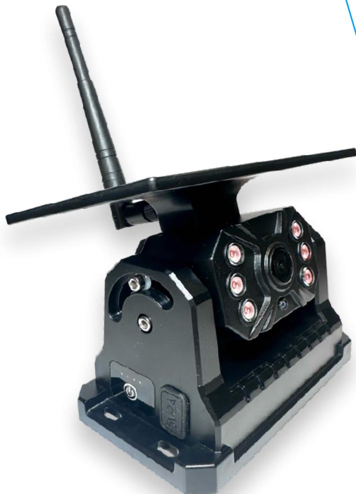
\* Un réseau wifi privé est transmis dans un rayon de 100m autour de la caméra en dehors de tout réseau wifi public d'une box ou d'un réseau cellulaire 4G, 5G. Le smartphone ou la tablette se connectent sur ce réseau privé via une application dédiée. Le wifi privé est complètement sécurisé car fermé aux autres utilisateurs et est idéal en zone blanche en dehors de tout accès internet wifi ou 4G, 5G.
