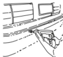
Bohren mit dem mitgelieferten Werkzeug (Lochsaäge).
