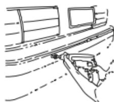
Perforación con la herramienta (sierra de perforación) suministrada con el kit.
