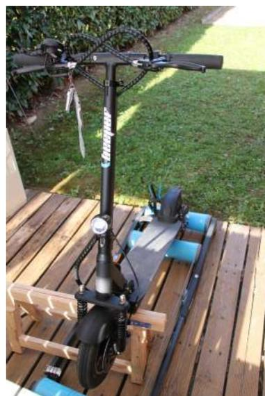
Tests réalisés sur un rouleau odomètre (calcul de la distance) pour recréer les conditions d'un parcours réel
